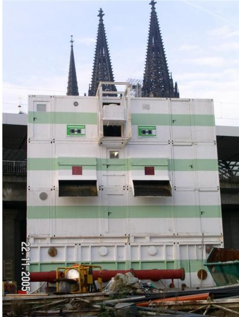
Abb.9: Beispiel für eine modulare Separieranlage (Nord-Süd-Stadtbahn Köln)
