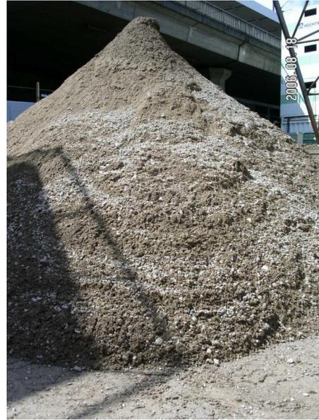
Abb.10: Separiertes Material aus Sand – Kies – Ablagerungen (gleiches Projekt).
