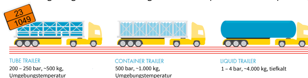
Abbildung A-3 Verschiedene Transportformen von Wasserstoff per Trailer, in Anlehnung an Shell Wasserstoffstudie
